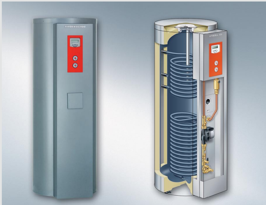
Rys. 30: Vitocell 100-U – biwalentny pojemnościowy podgrzewacz c.w.u. z zespołem Solar-Divicon, zintegrowanym orurowaniem i regulatorem solarnym Vitosolic 100
