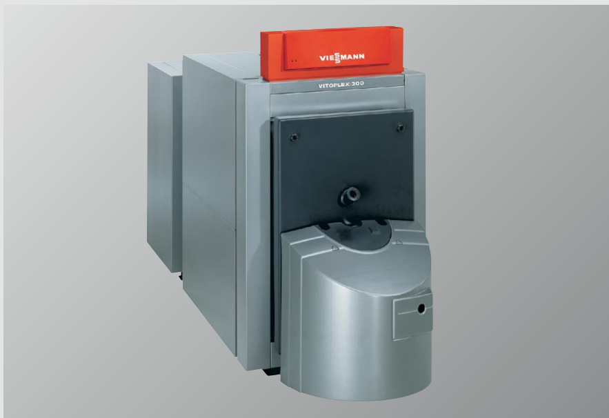
Rys. 50: Vitoplex 300 z przyłączonym wymiennikiem ciepła spaliny/woda Vitotrans 300 dla wykorzystania ciepła kondensacji w kotłach grzewczych od 80 do 6600 kW
