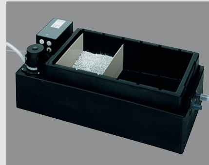
Rys. 39: Neutralizacja granulatem z pompą podnoszenia kondensatu, dla ilości kondensatu do 210 l/h, co odpowiada mocy cieplnej ok. 1500 kW
