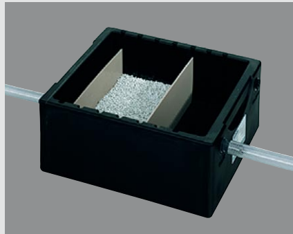
Rys. 38: Neutralizacja granulatem dla kotłów gazowych z ilością kondensatu do 70 l/h, co odpowiada mocy cieplnej ok. 500 kW
