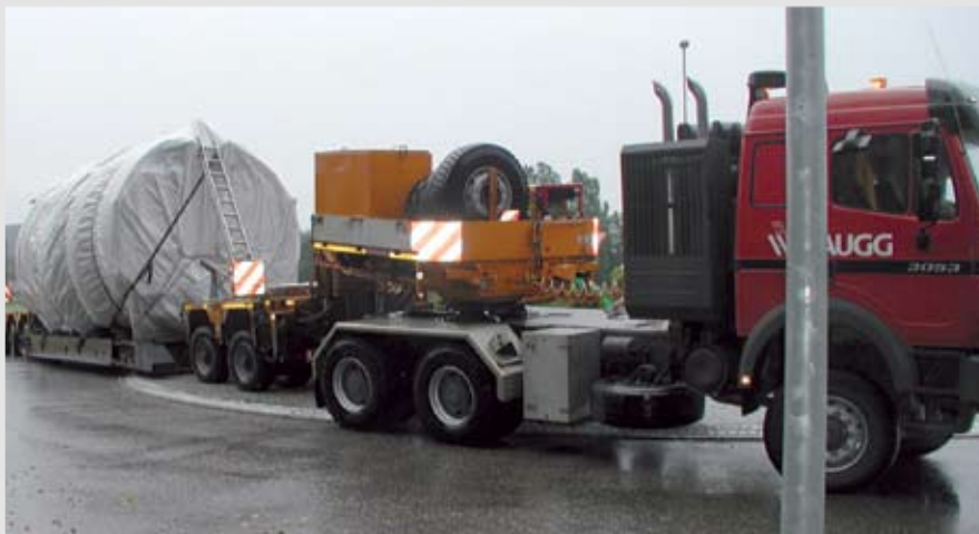
Rys. 78: Transport kotła parowego
