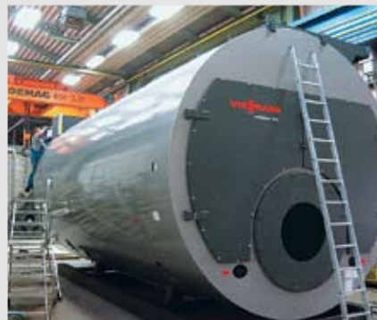
Izolowanie kotła w wytwórni
