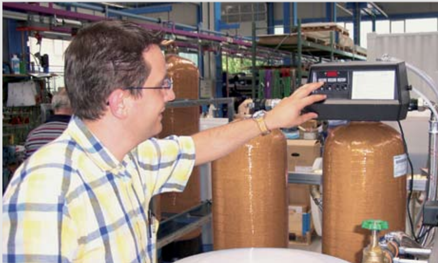
Rys. 49: Parametryzacja agregatu jonitowego do zmiękczenia wody
