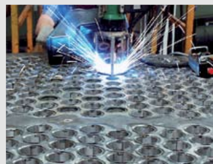
Spawanie płomieniówek robotem mechanicznym
