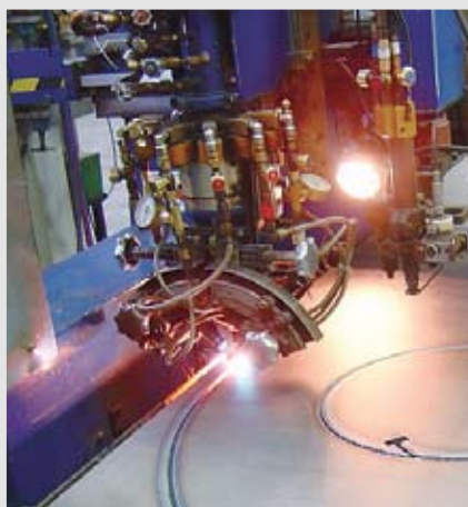
Spawanie płomieniówek robotem mechanicznym
