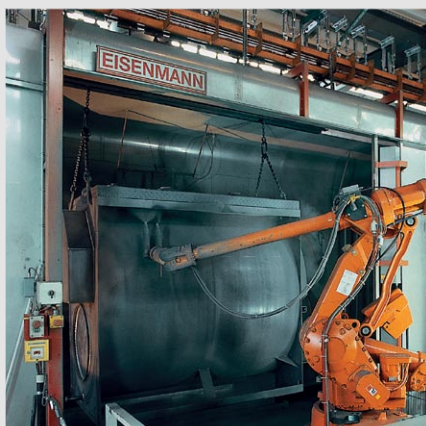
Także naroża i kany robot pokrywa ekologicznym lakierem proszkowym
