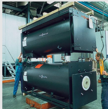
Górna i dolna część dzielonego kotła Vitoplex 300, typ TZ, przygotowywane do wysyłki
