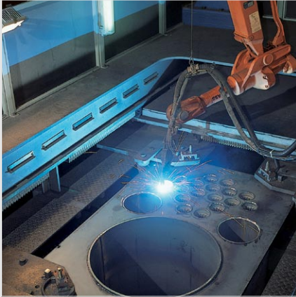
Wspawywanie wielowarstwowych ptomieniówek kotła Vitoplex 300
