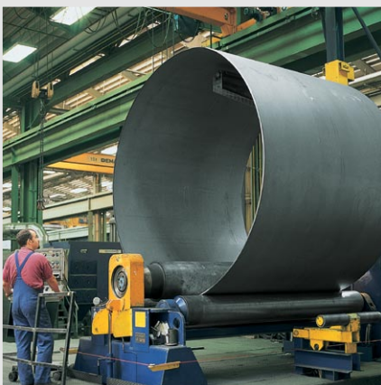
Zwijanie płaszcza kotła Vitomax
