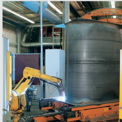
Robot spawalniczy wykonuje ścieg obwodowy na płaszczu kotła
