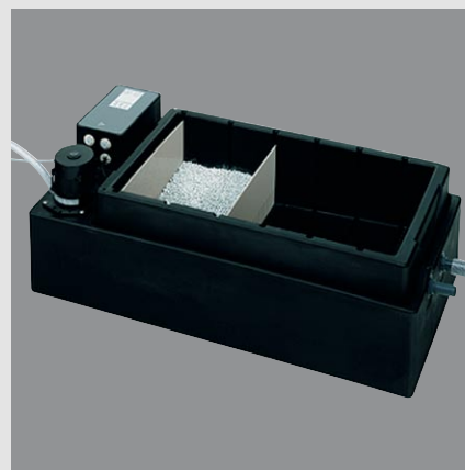
Rys. 36: Neutralizator granulatowy z pompą podnoszenia kondensatu – stosowany do ilości kondensatu do 210 l/h, co odpowiada mocy cieplnej ok. 1500 kW
