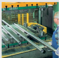
Produkcja wielowarstwowych rur Duplex dla Vitomax 300
