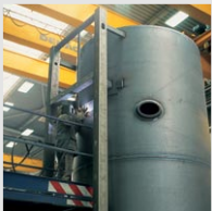
Spawanie w optymalnych warunkach – także przy długości kotła ponad 7 m
