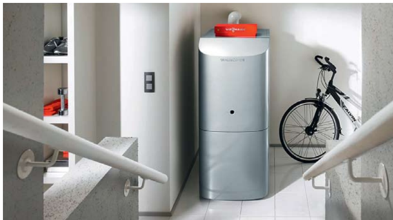
Kocioł Vitorond 111 posiada zintegrowany pojemnościowy podgrzewacz c.w.u., powierzchnia zajmowana przez kocioł nie przekracza 0,6 m 2 .
